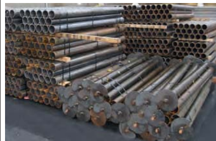
ORT- ruuvipaalu ilman pintakäsittelyä. Putki \varnothing 114,3 \times 6,3 mm, laippa \varnothing 250 mm. Parkkihallin lattian saneeraus. Suunnittelukuorma 140 kN, BDA-mitattu kuorma 187 kN, paalupituus 16 m.
